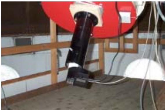
ST8 montée sur le réducteur de focale 5X pour les acquisitions de M16. Nous avons ajouté une entretoise pour utiliser un réglage du réducteur permettant de minimiser les reflets dus aux filtres (et reculant accessoirement le foyer).
