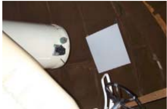
Acquisition des PLU sur panneau blanc
